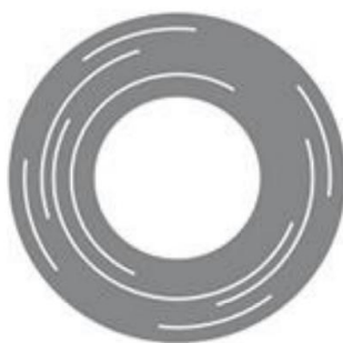
Rys2. Tarcza kodowa enkodera absolutnego
