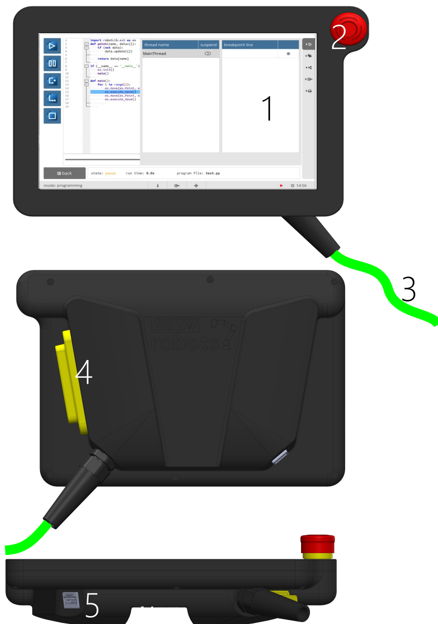
Rysunek 2.4: Panel sterujący robota: 1-Ekran wyświetlacza, 2-Przycisk awaryjnego zatrzymania, 3-Przewód zasilający i komunikacyjny, 4-Przycisk zezwolenia na pracę, 5-złącze USB
