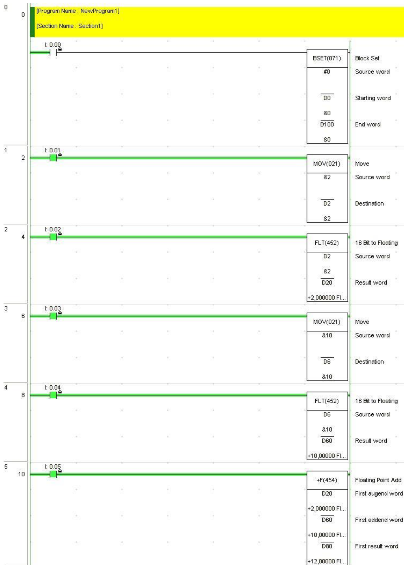
Rys 1.7 Dodawanie liczb zmiennoprzecinkowych
