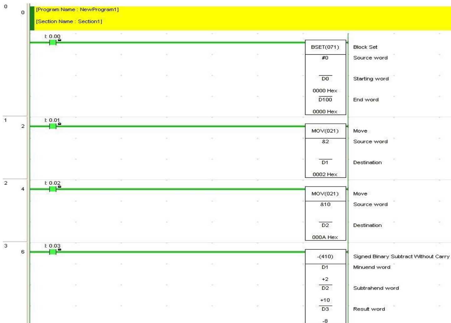
Rys. 1.2. Odejmowanie liczb 16b bez przeniesienia
